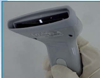
Hauptschalter einschalten, Auslöser drücken und rote LED prüfen.
